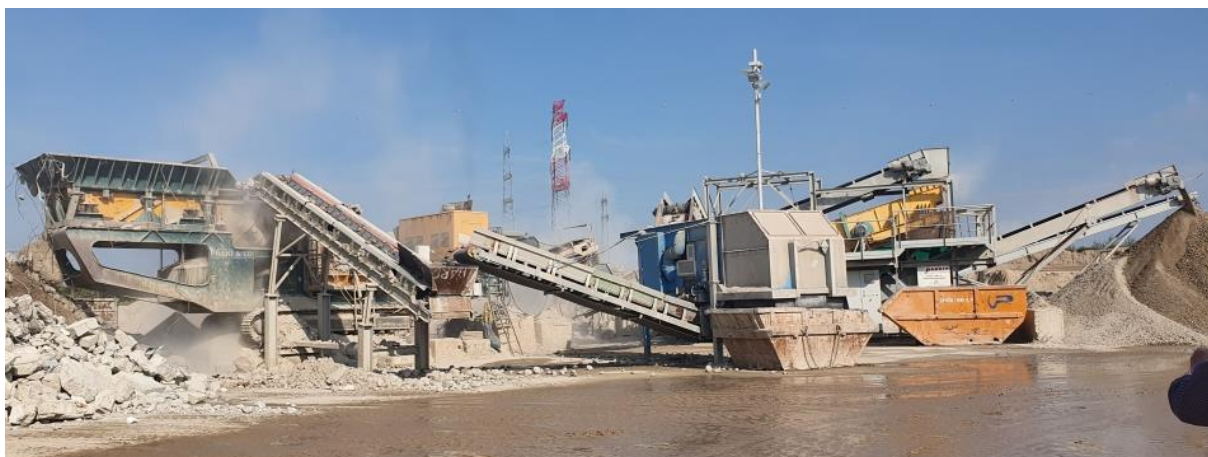
obr. 37 Recyklační linka pro betonovou suť. RCH Recycling Center Himberg GmbH, Himberg bei Wien
