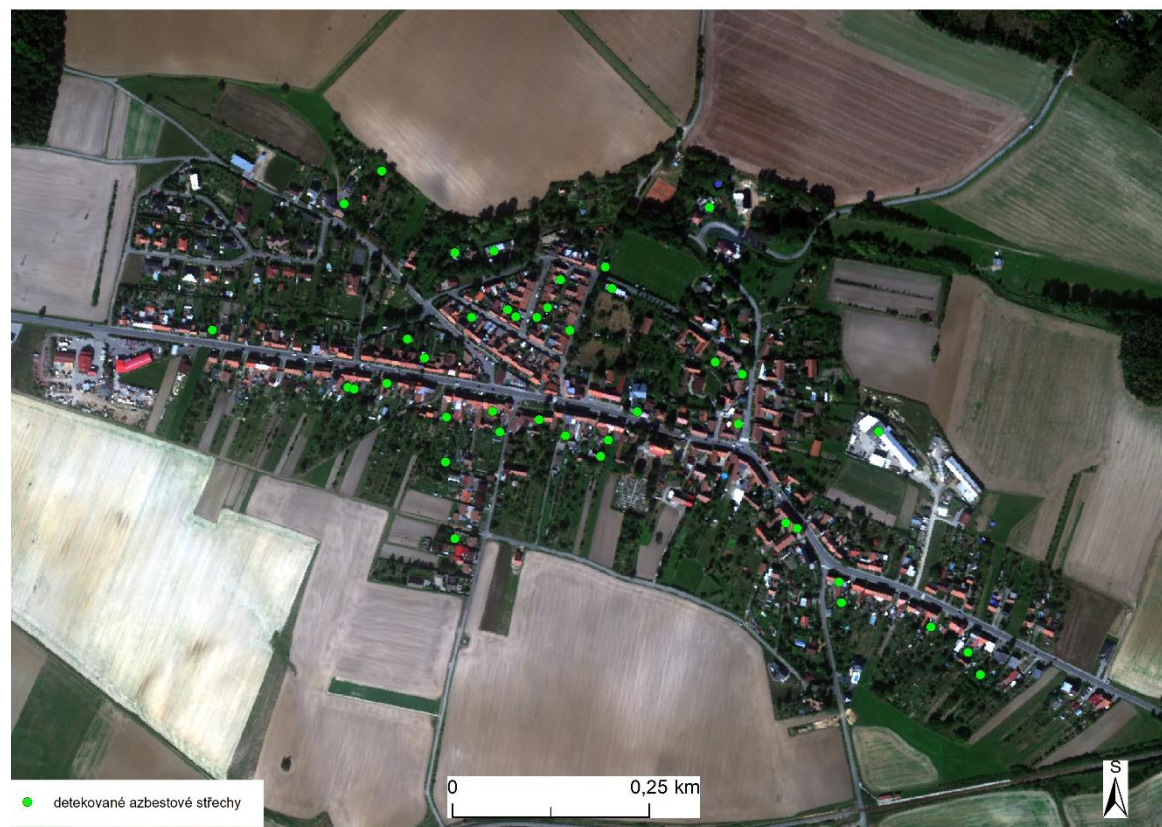
Obrázek 17: Výstup MNF Transformace pro obec Vysoké Popovice, bodově nalezené azbesto-cementové krytiny
