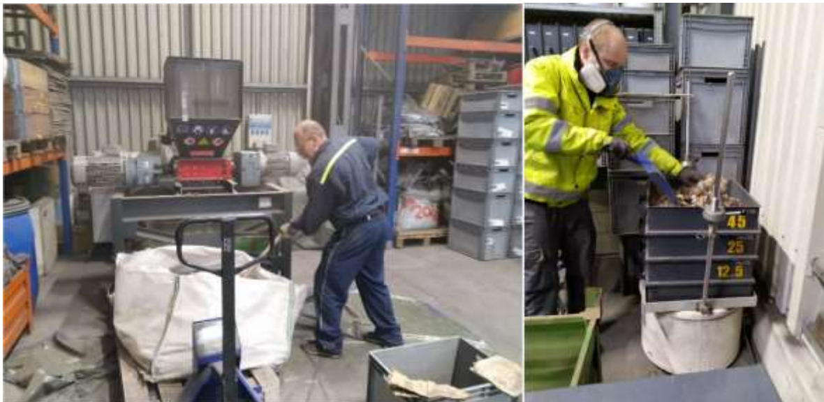
Obr. 14: Mechanická předúprava reprezentativního vzorku historického komunálního odpadu zacílená na získání analytických vzorků.
