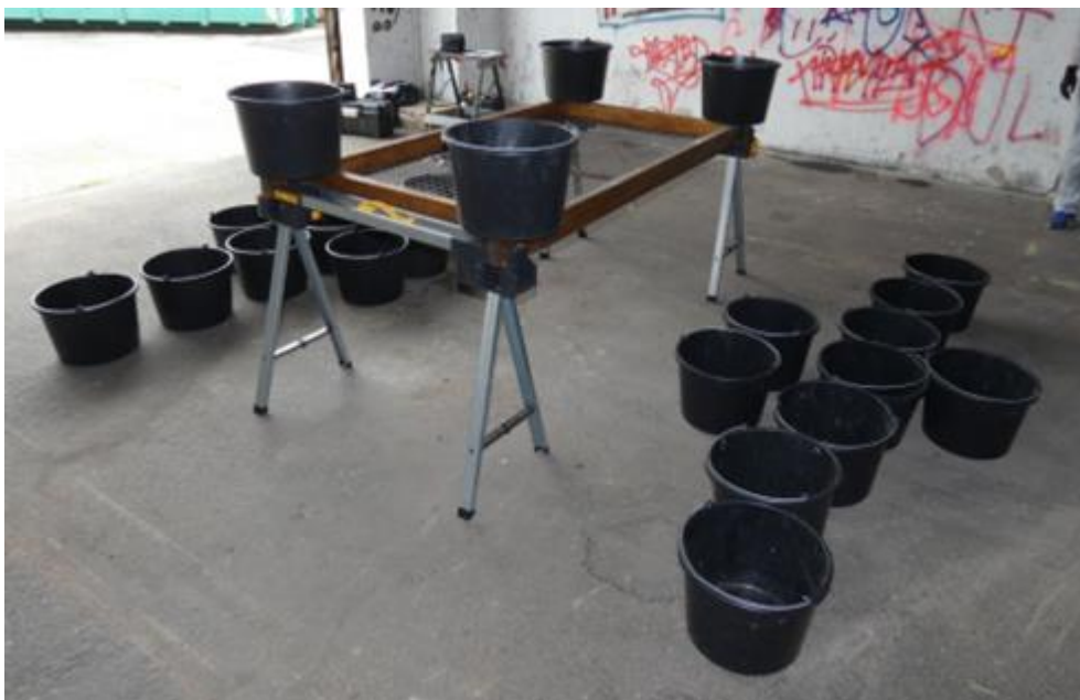
Obr. 2 Připravené třídící stanoviště s využitím síta (vhodné pro SKO)
