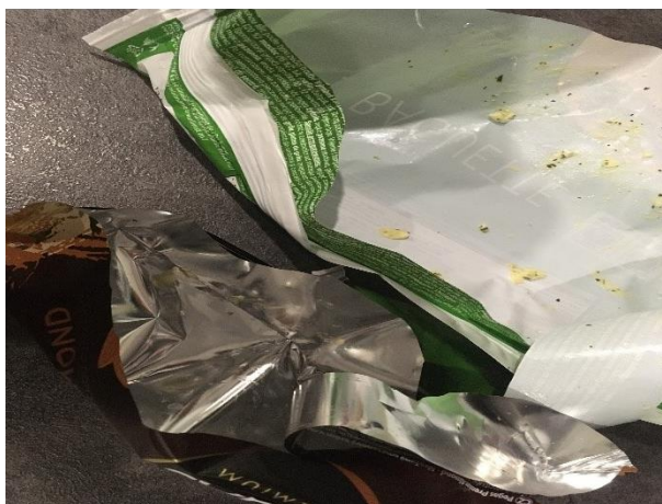
Obr. 12 Jednodruhová (nahore) vs. kompozitní (dole) obalová fólie
