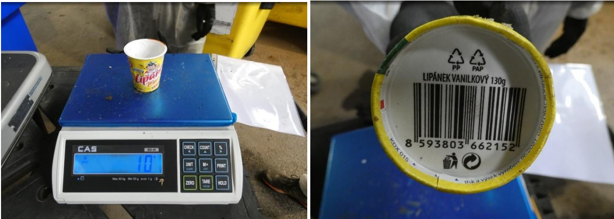
Obr. 10: Obal od jogurtu Lipánek s celkovou hmotností obalu 10 g, ukázka detailu recyklačního symbolu PP a PAP, oba materiály jsou od sebe snadno oddělitelné.
