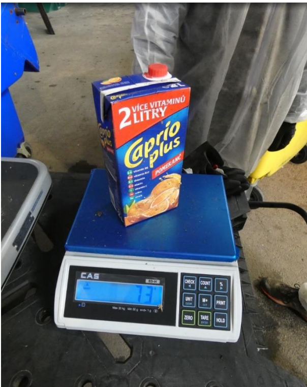
Obr. 9: Tetrapak od Caprio plus s celkovou hmotností obalu 73 g, ukázka detailu recyklačního symbolu C/PAP – kompozitní obal
