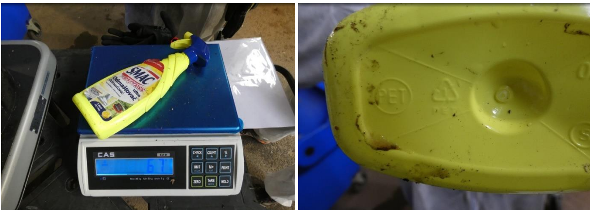
Obr. 11: Láhev od odmašťovacího saponátu SMAC s celkovou hmotností obalu 67 g, ukázka detailu recyklačního piktogramu 1 (PET), šroubovací rozprašovač je kombinace HDPE a kovu
