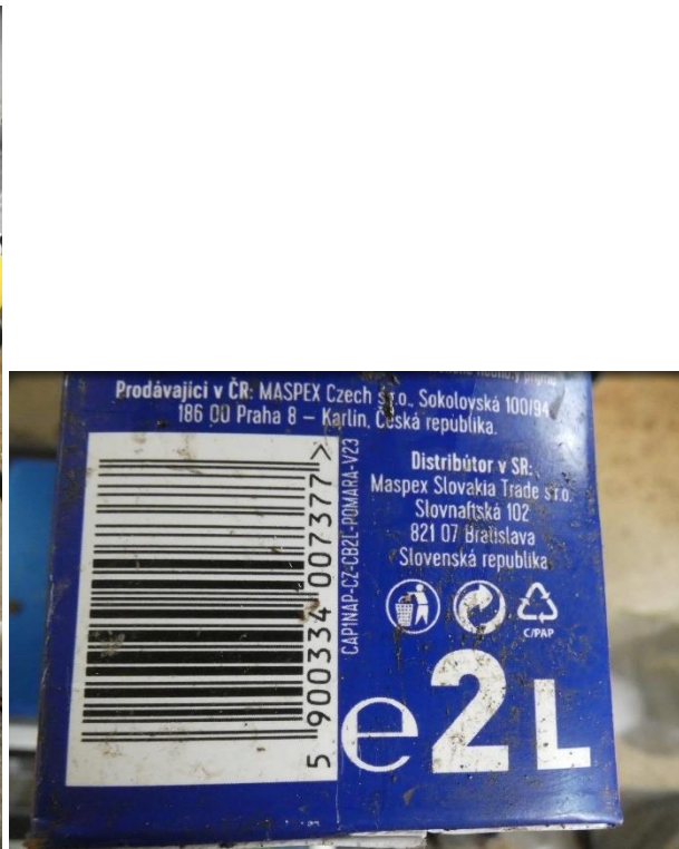
Obr. 9: Tetrapak od Caprio plus s celkovou hmotností obalu 73 g, ukázka detailu recyklačního symbolu C/PAP – kompozitní obal
