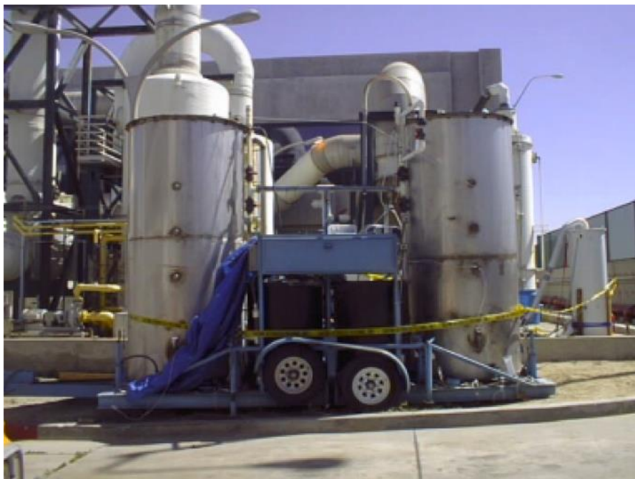
mobilní kombinovaný biofiltr a zkrápěný biologický filtr
